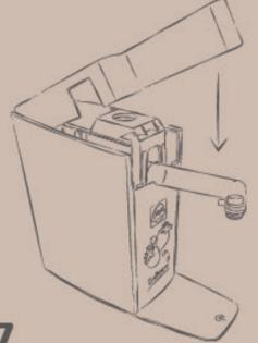
Motor einsetzen und Deckel aufsetzen.
